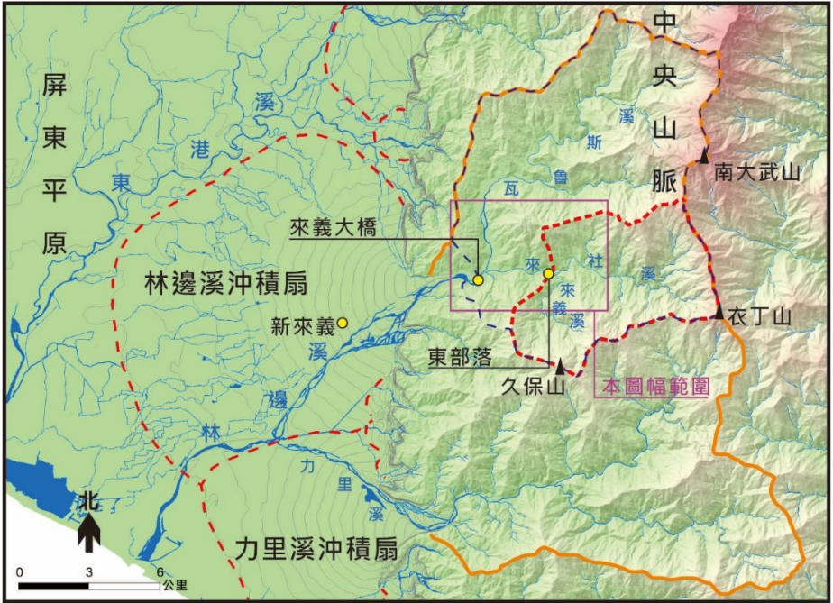
圖 4-3 本圖幅主要集水區分布圖。紅色點線為來社溪河道東部落河段的集水區、紫色虛線為林邊溪主流來義大橋河段的集水區、橘色實線為全林邊溪山區集水區範圍、紅色虛線為屏東平原上主要沖積扇範圍
