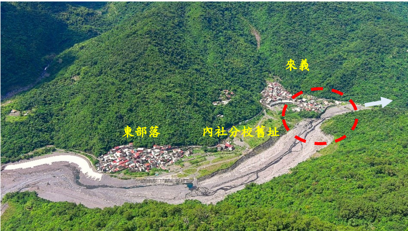
圖 4-9 來義扇階北側的河道隘口。此隘口可能導致來社溪主流洪水宣洩不易，形成回水導致內社分校舊址受災嚴重，且造成來義扇階的東北角被侵蝕出一彎月形河蝕崖（2022.11）
