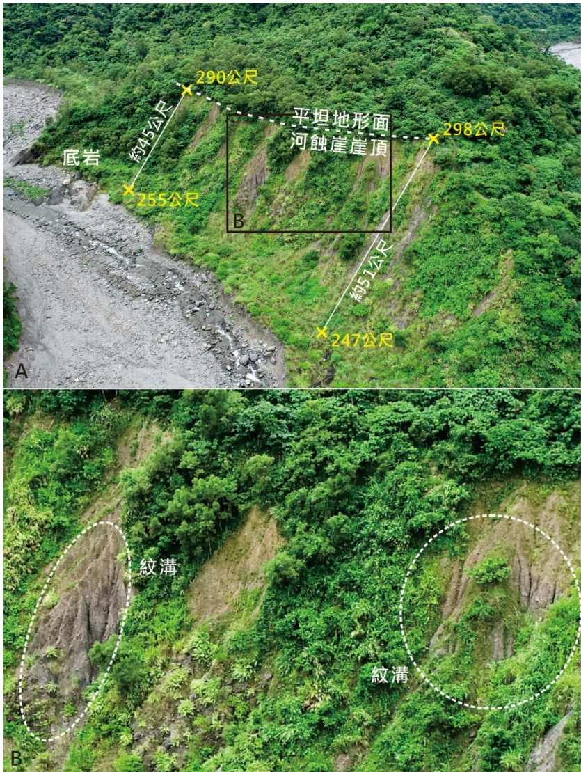
圖 3-4 Tjusapu 平坦地形面空拍照片。A：平坦面與當代河床面高度、垂直高差；B：河蝕崖崖面局部放大可見紋溝(2022.08)
