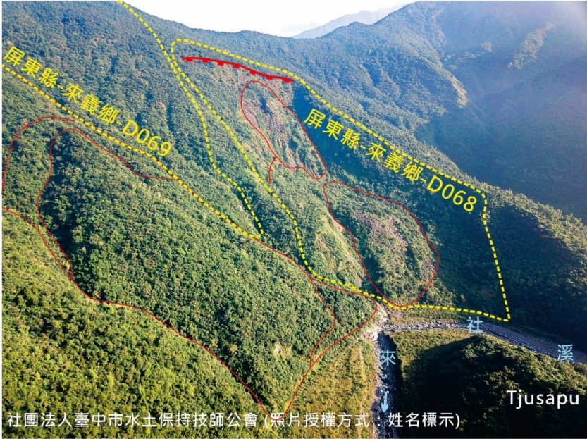
圖 3-7 Tjusapu 對岸潛在大規模崩塌區空拍照片 (2019.10, 原圖引用自農委會水土保持局歷史影像平台)。紅色圖徵為本說明書初步判釋之主、次崩崖及滑動體，位置可比對圖 3-5。其中「屏東縣-來義鄉-D068」潛在大規模崩塌區 (中央地質調查所圈繪)，於 2009 年莫拉克颱風造成的豪雨過後，就曾發生較大規模的岩體滑動。
