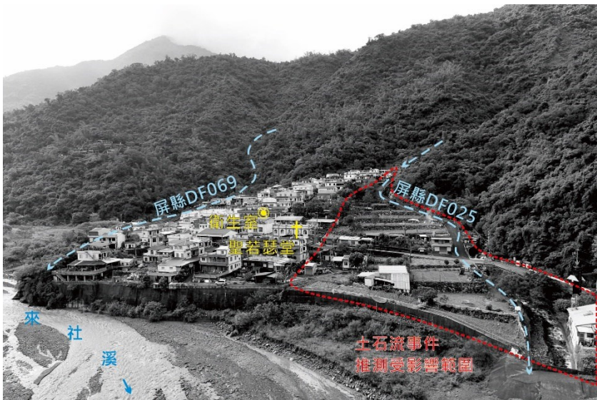
圖 2-3 來義西側野溪（屏縣 DF025）土石流影響的範圍，往西南方低角度空拍。紅色虛線範圍為訪談後推論的土石流事件影響區域；藍色虛線為野溪（土石流潛勢溪流）；來義聖若瑟堂、來義衛生室可供本圖幅主、插圖空間對位（2021.08）
