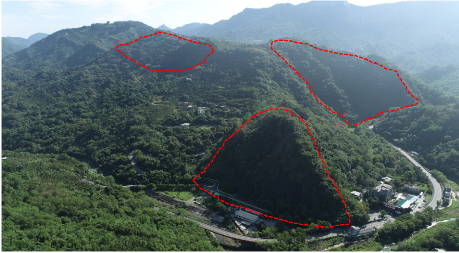
照片 2-1 巨型安山岩質崩落岩塊形成的山頭。紅色虛線圈起處為地質圖顯示之安山岩質凝灰角礫岩所形成的山頭,照片右下方為安通溫泉區(2020年9月9日攝)
