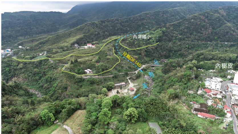
圖 3-10 投縣 DF146 土石流潛勢溪流谷口扇階。淺綠線示意扇階崖頂部位置。(民國 113 年 4 月 14 日攝)
