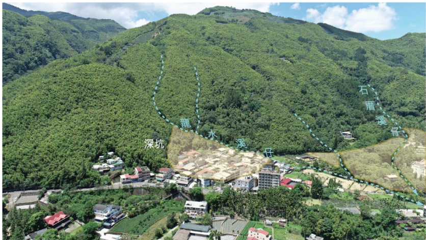
圖 3-14 深坑聚落之土石流扇（民國 113 年 7 月 17 日拍攝） 藍色虛線為溪溝，淺黃區塊為土石流扇。
