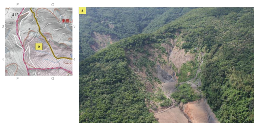
圖 5-1 莫拉克風災時，大鳥部落後方邊坡發生大規模岩屑崩塌 (東縣 LL006) 並產生土石流
